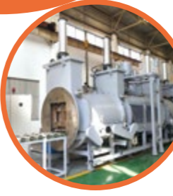
连续式氢化脱氢炉
